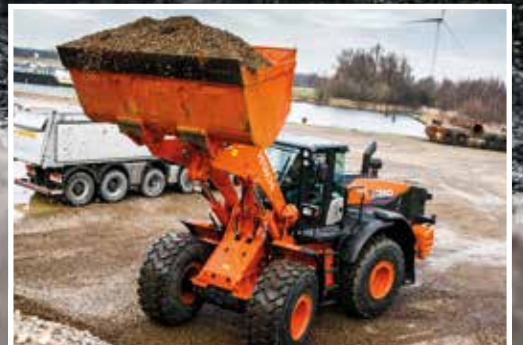
El sistema de control de flujo garantiza un movimiento suave del brazo de elevación.
