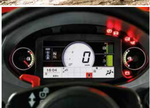
El monitor LCD muestra el estado y los parámetros de la máquina.
