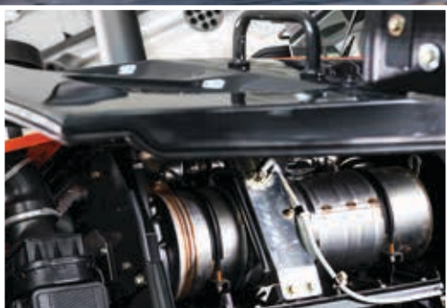
El sistema SCR reduce las emisiones.
