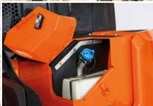
Para reducir las emisiones, se inyecta urea en los gases de escape.
