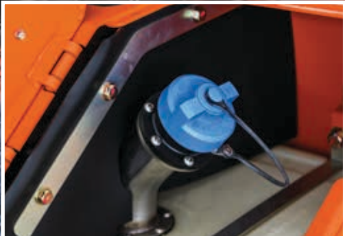
Para reducir las emisiones, se inyecta urea en los gases de escape.
