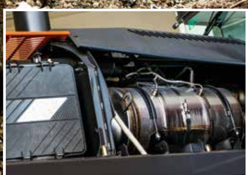
El sistema SCR reduce los niveles de emisiones y ruido.
