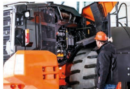
Acceso sencillo al compartimento del motor.
