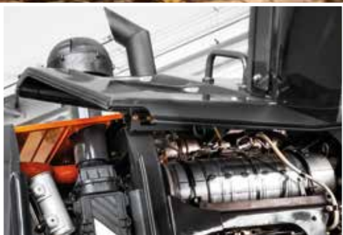
El sistema SCR reduce las emisiones.
