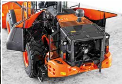
Las cubiertas se abren por completo para facilitar el mantenimiento.
