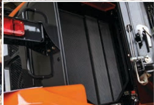
Los radiadores antiobstrucción opcionales mejoran la durabilidad.
