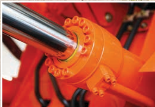
La función Ride Control (suspensión de brazos) garantiza la comodidad del operador durante el acarreo.
