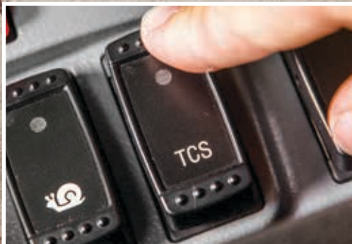
El sistema de control de tracción ayuda a evitar el deslizamiento del neumático en condiciones invernales o de suelos mojados.
