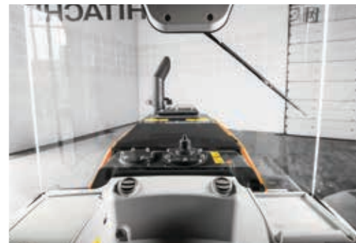
La visibilidad de la parte posterior se ha mejorado gracias al cambio de diseño.
