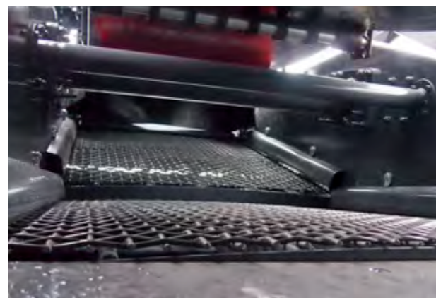
La criba de doble inclinación permite una separación eficiente y precisa.
