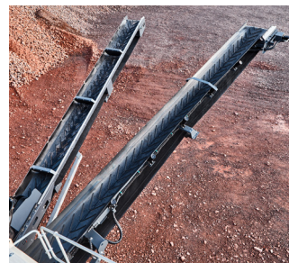
Bandas tipo Chevron para trabajo pesado para transportadores de elevación, de partículas de gran tamaño y laterales para una máxima durabilidad
