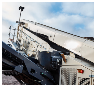
Elevación hidráulica del transportador de elevación como estándar, para permitir más espacio para el mantenimiento
