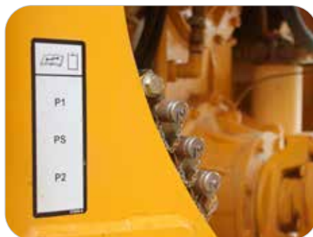
Puertos de prueba fácilmente accesibles permiten a los técnicos localizar los problemas con mayor rapidez.
