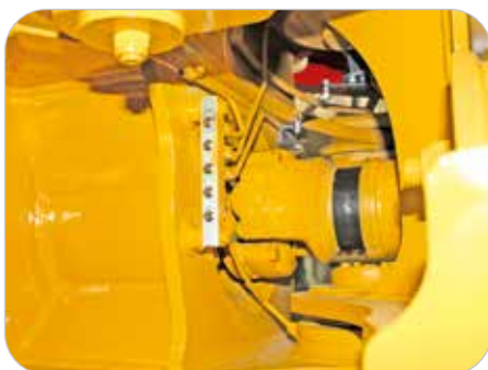
El banco de lubricación centralizado pone a su alcance los puntos de engrase de difícil acceso.
