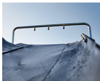
Sistema de rociado de agua para una supresión de polvo eficiente, bomba incluida
