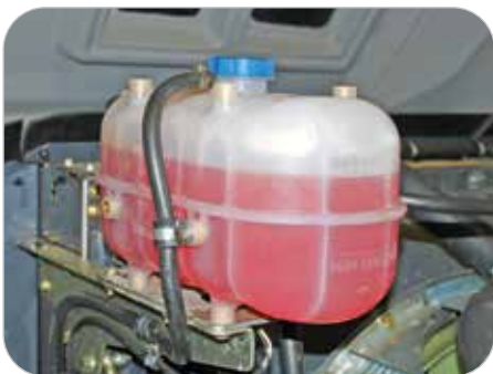
Depósitos de líquido transparentes y sus medidores de nivel le permiten comprobar el nivel de líquidos de un vistazo.
