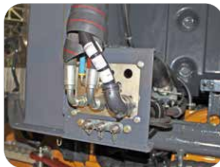
Puertos de diagnóstico fácilmente accesibles permiten a los técnicos localizar los problemas con mayor rapidez.
