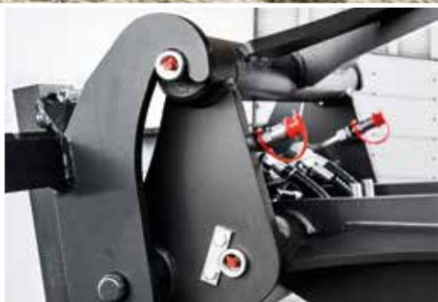
Enganche rápido de accionamiento electrohidráulico para conectar con más facilidad los implementos.
