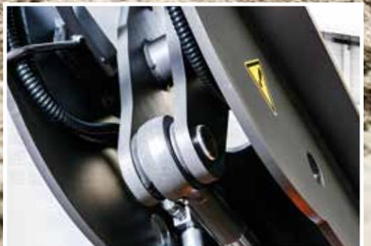
Las mangueras y el cableado internos del balancín único protegen los componentes más importantes.
