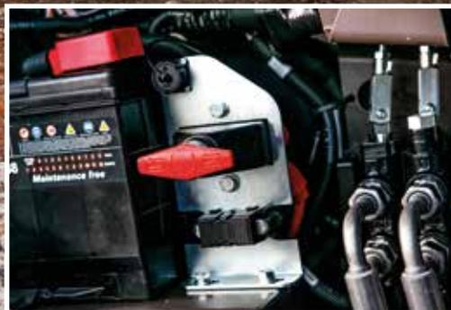
Interruptor de desconexión de la batería para facilitar las tareas de mantenimiento.
