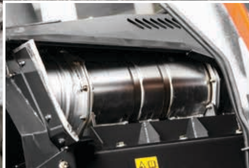
El sistema SCR reduce los niveles de emisiones y ruido.
