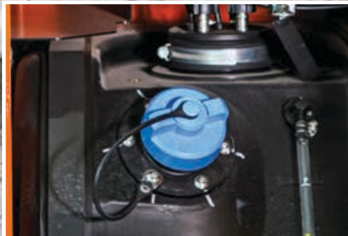
La posición del depósito de urea permite acceder al mismo de manera fácil y segura a nivel del suelo.
