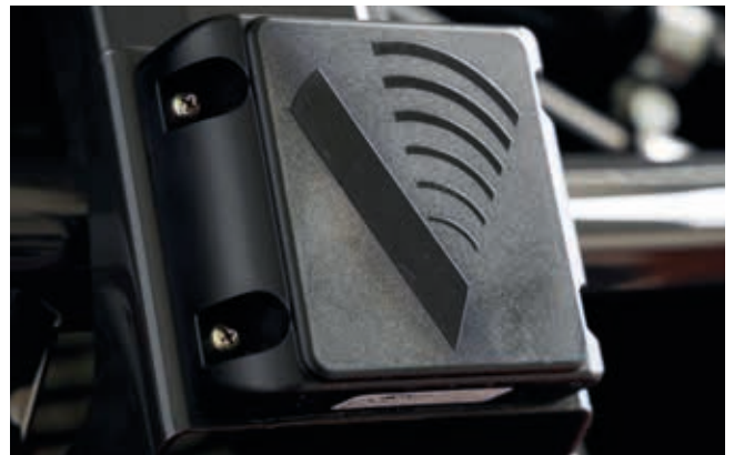
El sistema de detección de obstáculos traseros mejora la seguridad en el lugar de trabajo.
