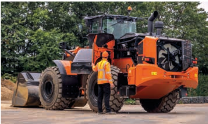
La cubierta del motor permite un acceso adecuado para las inspecciones diarias.
