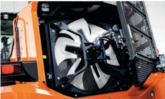
El sistema de operación inteligente del ventilador evita que los radiadores se obstruyan.
