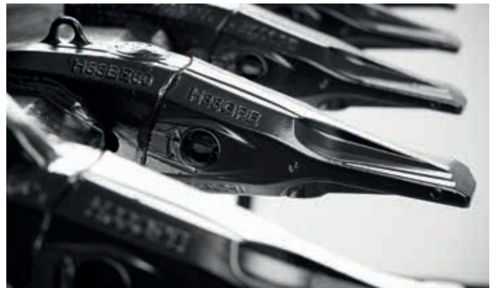
Los materiales de desgaste GET de Hitachi incluyen dientes autoafilantes y adaptadores fiables que garantizan un ajuste preciso.
