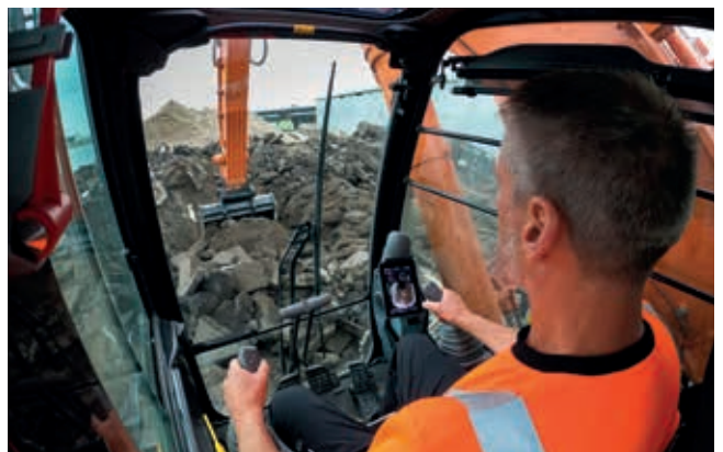
El amplio diseño del limpiaparabrisas proporciona una mayor visibilidad.
