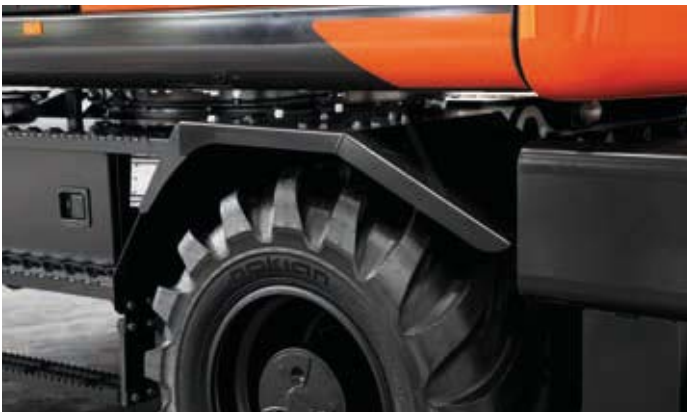
Los guardabarros en la estructura inferior protegen a la estructura superior y a las luces de la suciedad y mantienen la máquina limpia.
