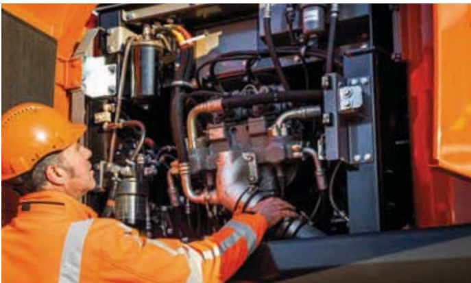
Las tareas de mantenimiento resultan más sencillas desde el suelo.
